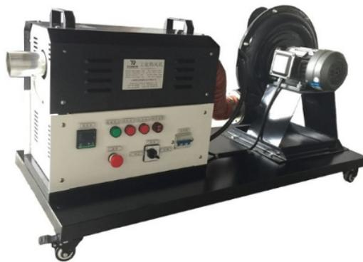
循环热风机这种设备是能够将热风加热后再吹出，比起其他品种的热风机来讲，是较节约电力的，并且，在作业的一同，能够降落周边的温度。十分适合在中止大型作业的时分运用，特别是在夏天的时分，也能够起到降温的效果。循环热风机曾经成为了现代工业热源升级换代的先选产品，并且，被普遍的运用到了食物、电子、制药、印刷等职业，是一个具有多功用的设备。不得说，这样的小型热风机都是干净卫生的，即使是在食物职业也能够抵达食物质量检测的规范，别的，由于往常的环境问题是十分严峻的，所以，这个设备就主动中止了环保的设置，各位运用者在运用的时分，完好不用忧虑会不会损坏环境卫生的状况。辽宁标准循环型热风机循环热风机装置时出风口须上倾15°，下倾10°范围内，机体左右倾度在15°范围内运用。
